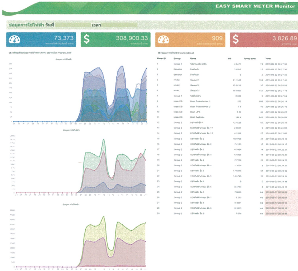
ภาพที่ 6 ตัวอย่างรูปแบบการแสดงผลการใช้และผลิตปริมาณไฟฟ้าที่ตรวจวัดได้ของเดิม
